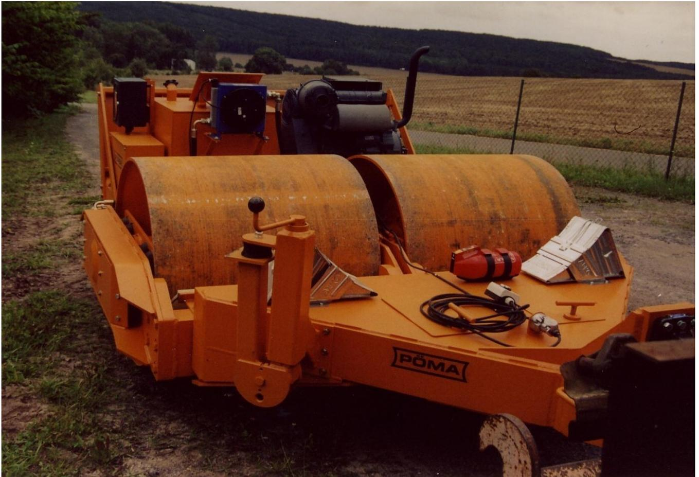
Die PÖMA – Anhänge- Vibrationswalze ist eine Doppelbandagenwalze für den Bau und Instandsetzung von Land- und Forstwirtschaftswegen mit Rundprofil. Beide Bandagen sind pendelnd am Hauptrahmen befestigt und können sich dadurch automatisch dem Wegeprofil anpassen. Die Maschine bewirkt eine hohe Verdichterleistung bei sehr guter Schwingungsdämpfung gegenüber Rahmen und Zugfahrzeug.
