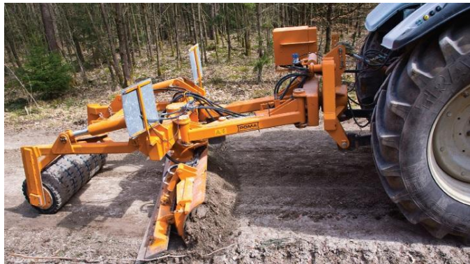
Das vordere Graderschild stellt das Profil wieder her, Abziehschild und Walze verdichten gleich wieder
