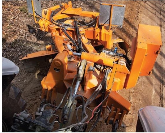
Mit dem Parallelrahmen verschwenkt man die Schilde, das massive Drehgelenk könnte vom Aufsattelpflug stammen
