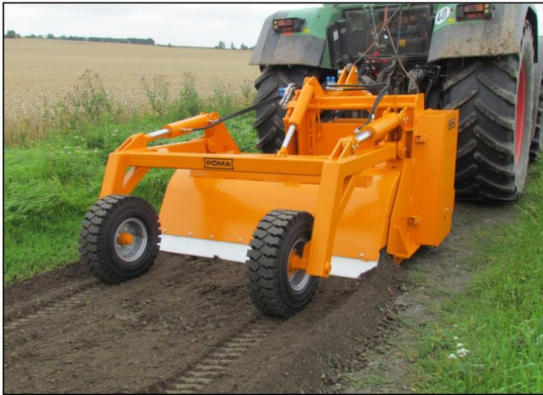
Der PÖMA – Steinbrecher wird für die Sanierung von Wirtschaftswegen mit wassergebundener Decke eingesetzt. Infolge von Erosionen sowie durch mechanische Belastungen wird die Verschleißschicht allmählich abgetragen bzw. deformiert. Dabei gelangen Steine verschiedener Größen an die Oberfläche.
