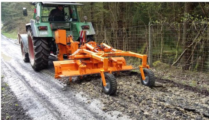
Mit dem nachlaufenden Abziehschild mit verschleißfester Stahlschiene wird der Weg geglättet und andgedrückt. Dabei werden Grassodenreste und Erdanteile zerbröseln und auf der Wegeoberfläche fein verteilt. Diese Partikel werden beim nächsten Regen seitlich vom Weg abgeschwemmt. Damit wird bei geeigneter Feuchtigkeit eine überraschend gute Verdichtung erreicht. Es wird nicht nur ein gutes optisches Resultat, sondern auch Schutz vor Erosionsschäden durch Starkregen erzielt.
